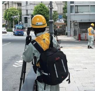
三次元レーザスキャナ及びドローンを用いて、鉄道敷地内・道路上の地形、地物の三次元点群データを作成します。現地測量で平面図を作成する方法に対し、短時間で広範囲に計測できます。高精度な三次元点群データを取得し、設計・施工、施工後のメンテナンスにも活用されています。
