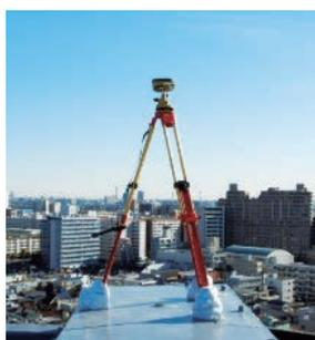
人工衛星から送信される衛星電波を利用し現在位置を計測する方式です。トータルステーションを用いた測量と比較して、時間と労力が大幅に軽減されました。GNSS測量は、天候に左右されることなく高精度の測定が可能です。弊社では基準点測量等、幅広い分野にGNSSを活用した測量業務を実施しております。
