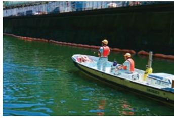
水上において船の位置と、水深の測量を同時に行う測量作業です。弊社では、この測量において、GPS・ソナー搭載自律走行無人ボートを使用しております。有人ボートでは困難な浅瀬や危険水域での測量調査が可能となり、座礁、転覆、転落事故のリスクを軽減しました。また、測量時間の短縮に成果を上げております。
